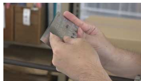
点字名刺製作の様子（一枚ずつ名刺を原盤に挟み印刷機に通して刻印）
