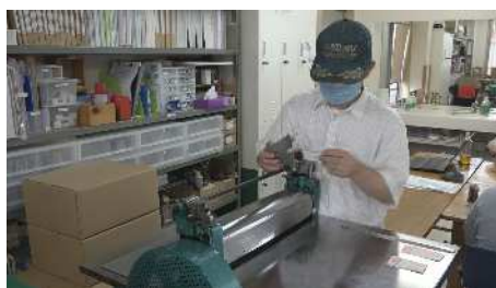
点字名刺製作の様子（一枚ずつ名刺を原盤に挟み印刷機に通して刻印）
